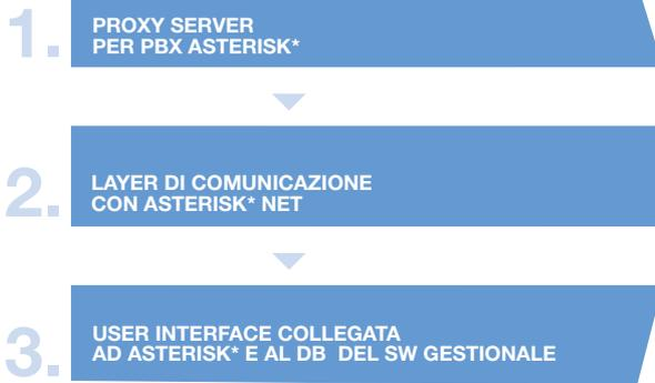
1. Il **Proxy Server di Asterisk\*** utilizza un'unica connessione al centralino, riducendo il traffico TCP/IP con Asterisk\* Server, garantendone stabilità e performance.
